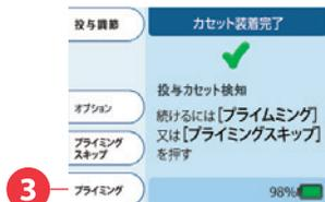
3. カセット装着完了画面でポンプセットが正しく装着されたことを確認し、**プライミングボタン**を押します。
