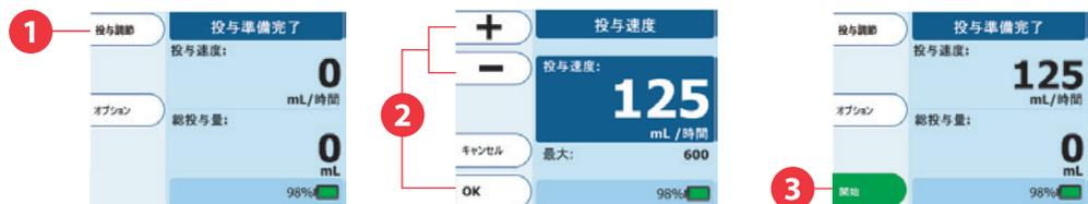
1. プライミングが完了したら、**投与調節**→**投与速度**を押して投与速度を入力します。
