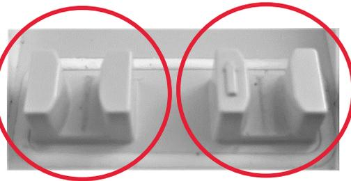
超音波センサー付近に汚れ、ホコリ、水滴が付着していると正常動作、ポンプテストに影響があります。閉塞エラーやE70エラーが発生する可能性があります。
