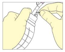
4. 静かに握るようにバルブ型ポンプを圧縮し、ポンプ内の空気を排出します。
