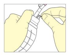
5. ポンプ内の空気を十分に排出 した状態で排出口キャップを 閉じます。
