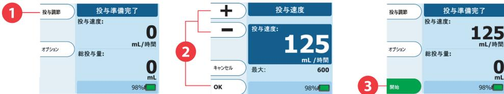
1. プライミングが完了したら、**投与調節**→**投与速度**を押して投与速度を入力します。
