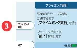
1. プライミングボタンを押すと上記の画面が表示されます。画面上の注意を確認後に**自動プライミング**か**プライミング実行**を選択します。
