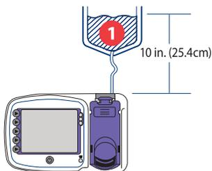
1. 図のように、投与する栄養剤の水面がポンプ上端の10インチ(25.4cm)上にくるように、投与バッグまたは栄養コンテナを吊るします。
