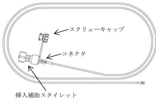
本品は経鼻的に挿入し、胃、十二指腸または空腸に留置して栄養投与を行うチューブで、先端に錘が付いており、挿入が容易に行えるよう、スタイレットが装着されている。また、コネクタはISO 80369-3の形状に適合している。
