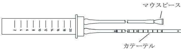
本品は、新生児の口腔内、気管、外耳等から羊水等を吸引除去するために使用するもので、カテーテル先を新生児の気道等へ挿入し、トラップ管を垂直に保持して吸引管端より口で吸引し、排液をトラップ管内に貯留するものである。
