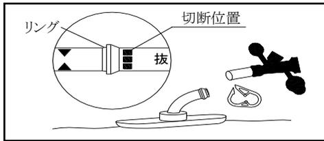
4. 軽く抜去用エクステンダーを押し込み、反発力を確認する。反発力を感じないときは抜去用エクステンダーの先端がバンパー中心の穴に嵌まっていないことが考えられるので、抜去用エクステンダーの挿入操作をやり直す。
