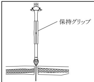
6. 挿入用エクステンダーを少し押し込み、挿入用グリップスターのフックから挿入用エクステンダーのリングを外す。
